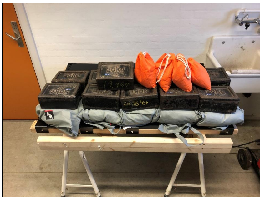
Billede 4. Testopstilling ved snelast, forside, 278 kg (TI, 2020)
