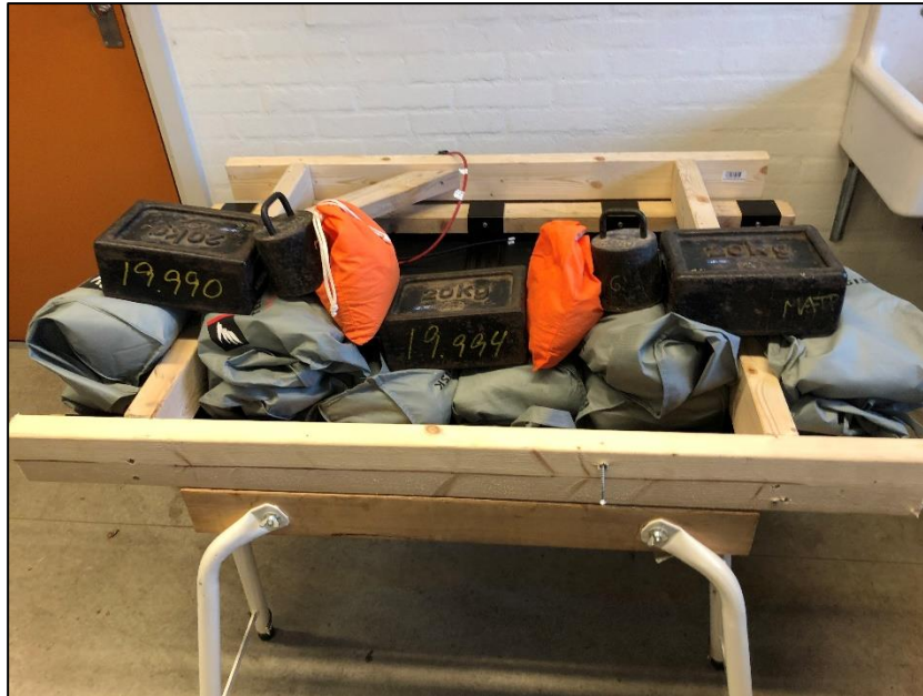
Billede 3. Testopstilling ved vindlast, bagside, 123 kg (TI, 2020)
