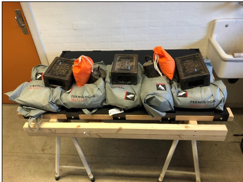
Billede 2. Teststilling ved vindlast, forside, 123 kg (TI, 2020)
