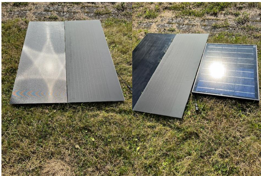
Figur 3 Udendørs fotos af genskin fra det testede modul i sollys sammenlignet med et modul med pyramidestruktur i glasset (til venstre) og et ældre demo-modul (til højre).
